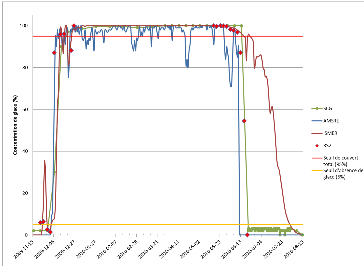
Figure 8 Concentrations de glace dans la baie Diana, régime des glaces 2009-2010, à partir de quatre différentes sources.
